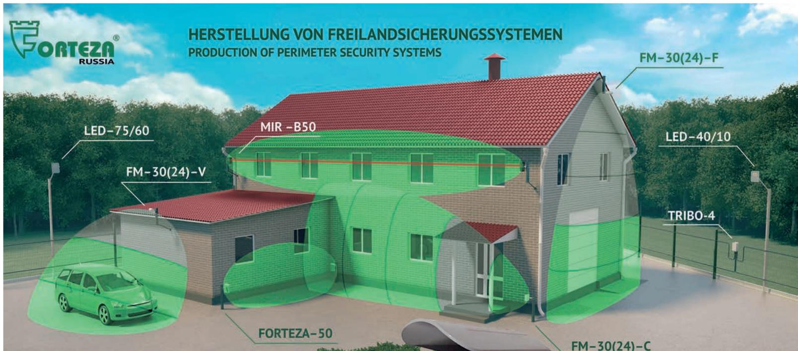
Monostatische Melder haben den Vorteil, dass sie nur einseitig verkabelt werden müssen, können aber nur bis zu 50m Entfernung eingesetzt werden. Diese Melder sind extrem robust gegen Witterungseinflüsse und Kleintiere.
